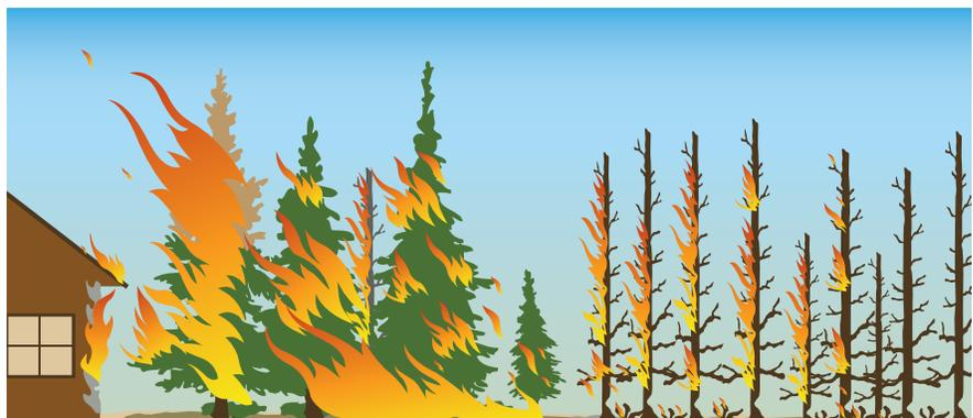
**Figure 4-2.** Les arbres et les arbustes en combustion produisent des flammes qui sont en contact direct avec le parement et la toiture de la structure adjacente<sup>28</sup>
