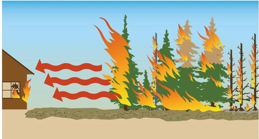
**Figure 4-3.** Transfert par rayonnement de la chaleur et de l'énergie provenant des arbres enflammés à la partie latérale de la structure<sup>30</sup>
