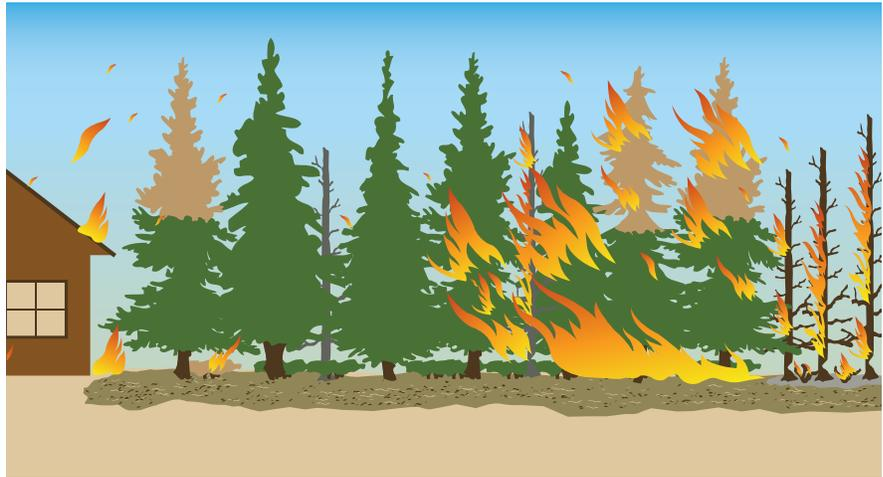
**Figure 4-1.** Effet des braises provenant d'un feu de végétation adjacente à une structure qui atterrissent sur son toit et sur la végétation avoisinante et allument des feux disséminés<sup>25</sup>
