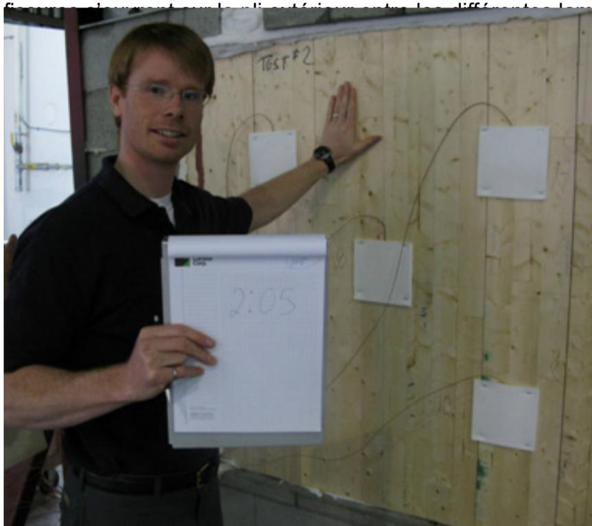
**Figure 3.6 – Photo prise durant un essai de résistance au feu réalisé sur un panneau mural de CLT à trois plis après deux heures et cinq minutes d'exposition au feu. La surface non exposée est encore relativement fraîche.**
