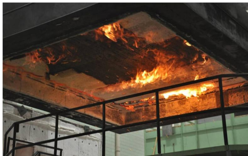
**Figure 3.4 – Photo prise à la fin d'un essai de résistance au feu effectué sur un élément de plancher en bois lamellé-croisé de trois plis et protégé par du panneau de gypse.**
