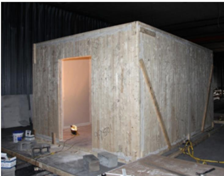
**Figure 3.11 – Pièce meublée (mobilier de chambre à coucher) en CLT construite pour un essai de compartiment coupe-feu réalisé à l'Université Carleton.**
