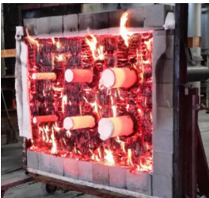
**Figure 3.10 – Dispositifs d'essai de résistance d'un coupe-feu (côté exposé) après 90 minutes d'exposition à l'essai de résistance au feu.**
