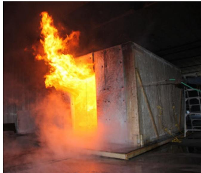
**Figure 3.12 – Pendant l'essai de résistance au feu réalisé sur la pièce en CLT comportant du mobilier de chambre à coucher à l'Université Carleton.**
