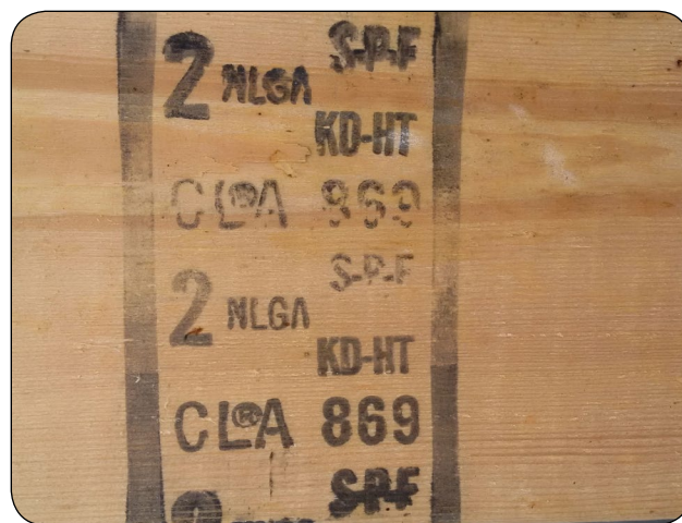
Figure 1. Exemple d'estampillage. Ces sciages ont été classés conformément aux règles de classement de la NLGA par l'Association canadienne de l'industrie du bois et ils ont été produits par la scierie numéro 869. Ce bois d'œuvre est constitué d'épinette-sapin-pin, il a été séché au séchoir, traité à la chaleur et s'est vu attribuer une classe 2.
