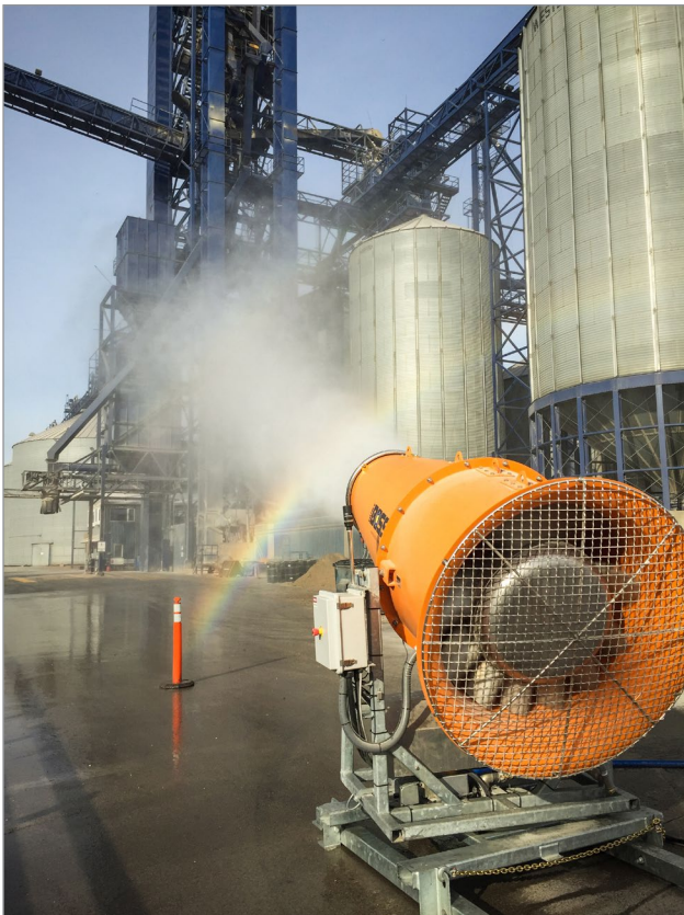
Figure 7. Les canons à brouillard, comme le modèle DustBoss illustré ici, sont utilisés par divers types d'industrie, contre les émissions de poussière diffuses. Source : BossTek, Peoria, Illinois.
