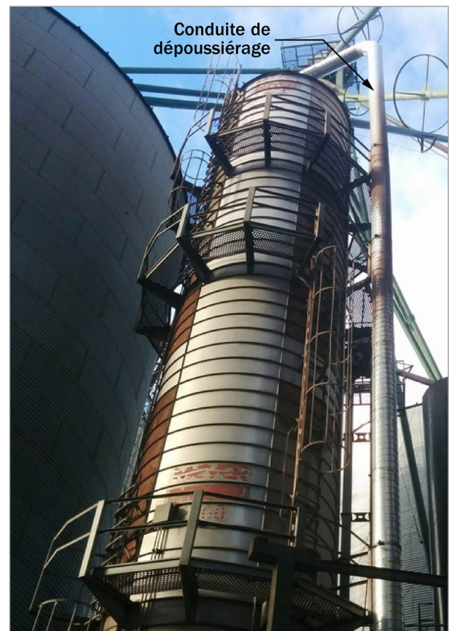
Figure 5. Séchoir vertical auquel est fixée une conduite de dépoussiérage. La conduite est reliée à un filtre cyclonique permettant de retenir les particules fines et les poussières rougeâtres des grains qui entrent par le haut du séchoir.
