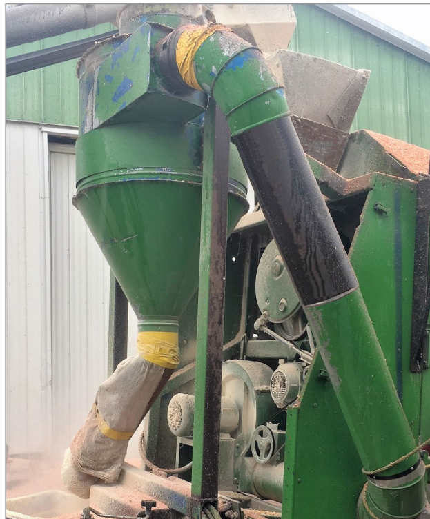
Figure 6. Un séparateur cyclonique, comme celui qui est illustré ici, sur un système de nettoyage du grain, fonctionne par des mouvements de rotation et utilise la gravité pour retirer les particules fines d'un flux d'air.
