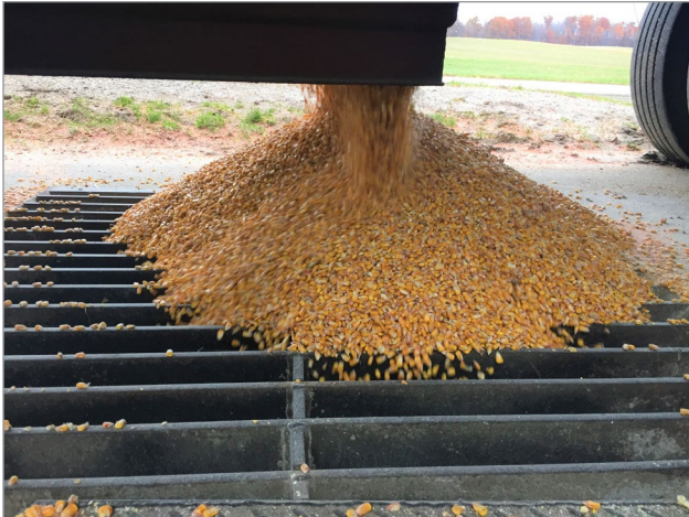
Figure 3. Réduire jusqu'à 90 % de la production de poussière en laissant les grains former un tas autour de la grille de réception au moment du déchargement, formant ainsi une sorte de goulot d'étranglement qui ralentit la chute du grain.
