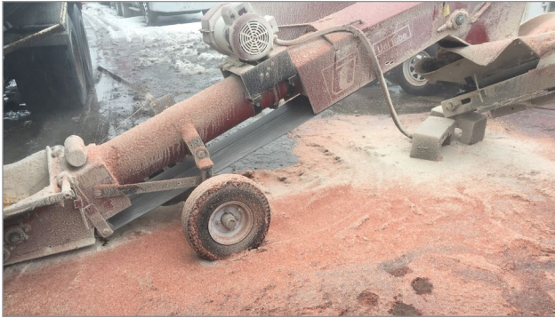
Figure 1. La poussière de grain sous forme de paillettes rougeâtres représente le type le plus fréquent d'émission de poussière issue des systèmes de manutention du grain. Cette poussière se distingue par sa couleur rouge-orangé et elle peut être produite en grande quantité lorsqu'on manipule du maïs.
