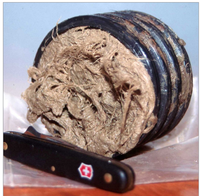
Figure 2. Un rinçage de la section du tuyau illustrée à la figure 1 révèle que l'obstruction est également due aux racines qui retiennent les fines particules de sol présentes dans l'eau de drainage.
