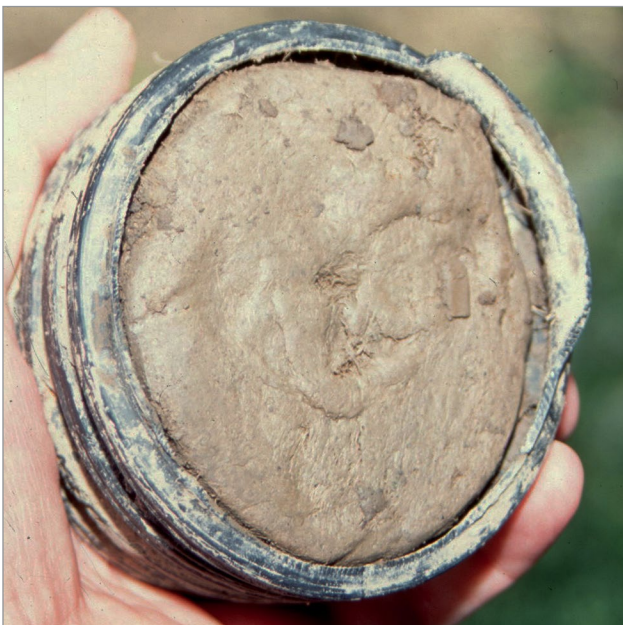
Figure 1. Au premier coup d'œil, ce tuyau de drainage semble obstrué par du sol.
