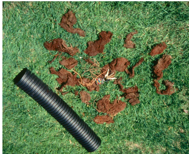
Figure 5. Masses de racines retirées d'un tuyau de drainage à proximité de pêchers. Bien que la situation soit rare, il arrive, comme on le voit ici, que des tuyaux de drainage soient obstrués par les racines d'arbres, comme le pêcher, qui affectionnent les milieux secs.
