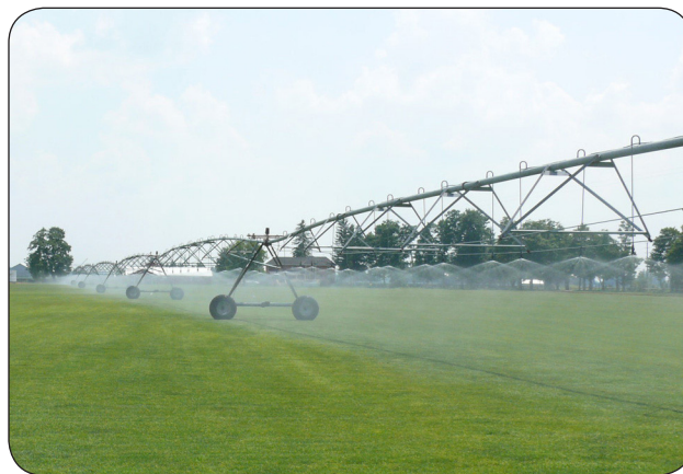
Figure 1. Irrigation dans une gazonnière au moyen d'un système à déplacement latéral muni de buses à faible pression.
