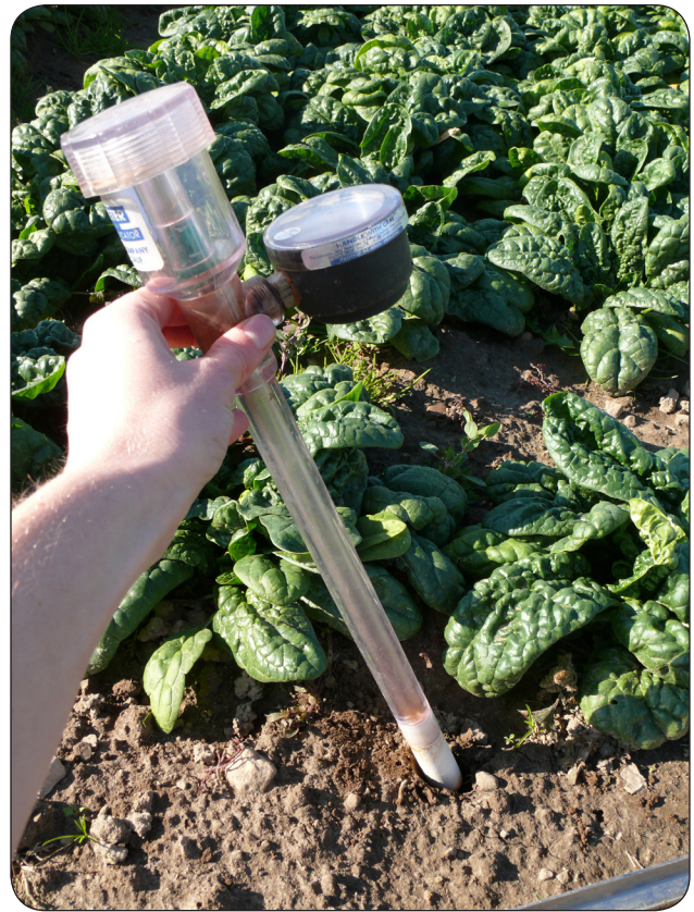
Figure 2. Mesure prise à l'aide d'un tensiomètre, appareil servant à mesurer le niveau d'humidité du sol.
