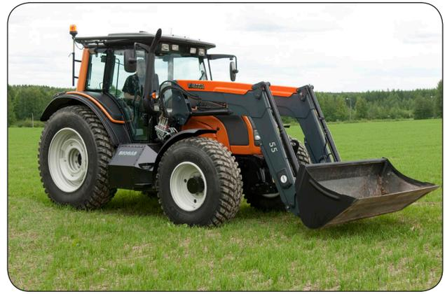
**Figure 2.** Tracteur hybride pouvant être alimenté au diesel ou au biogaz. Photo : AGCO Valtra.
