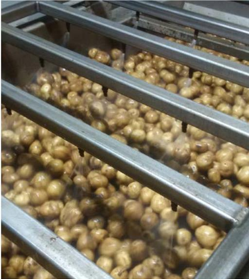
**Figure 2.14. Pommes de terre recevant un dernier rinçage.**
