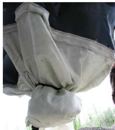
Figure 8.22. Orifice à la base d'un sac filtrant réutilisable.
