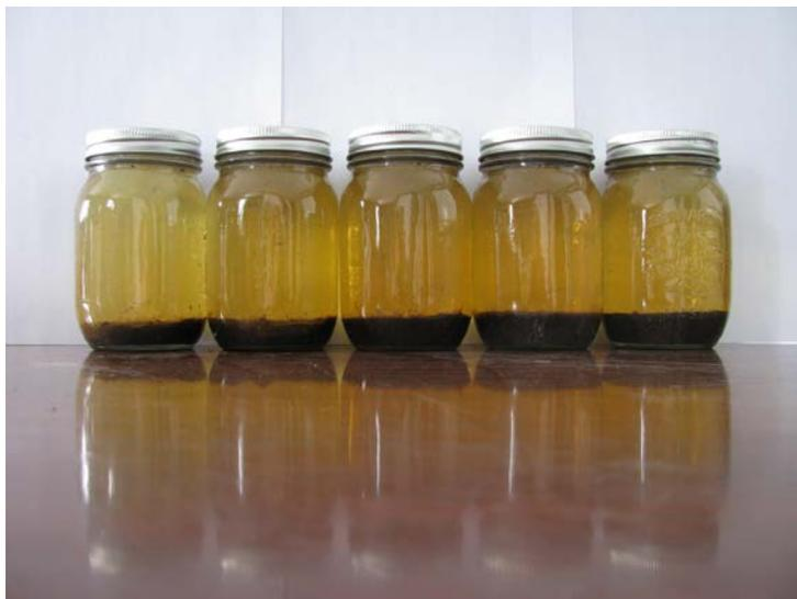
**Figure 11.2. Quantité de matières solides dans les déchets pour différentes durées de cycle de pulvérisation (de gauche à droite) soit 25 secondes, 20 secondes, 15 secondes, 10 secondes et 5 secondes.**
