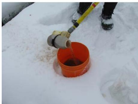
**Figure 5.2.** Utilisation d'un seau pour combiner des échantillons.
