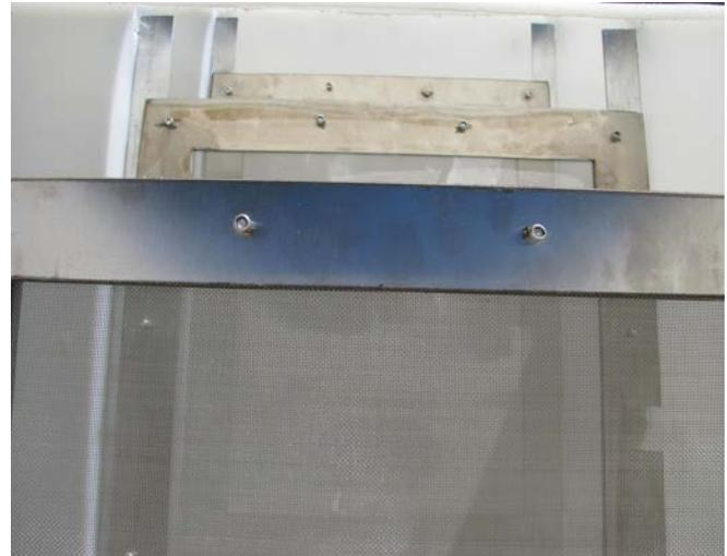
Figure 8.8. Vue intérieure d'un filtre progressif passif.
