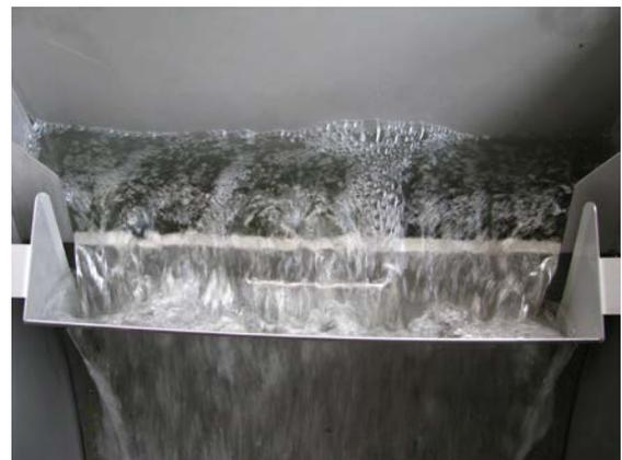
Figure 8.5. Filtre à tamis parabolique avec un plateau métallique pour diriger l'eau sur le tamis.
