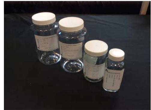
**Figure 5.8. Jeu de bouteilles d'échantillonnage étiquetées.**
