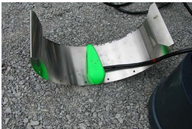
Figure 4.3. Capteur installé sur une bande de tuyau.
