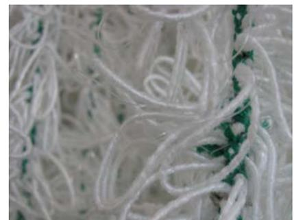
**Figure 8.33. Mailles synthétiques (un matériau synthétique) dans un BioCord® .**
