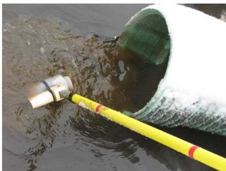
**Figure 5.1.** Utilisation d'une perche d'échantillonnage pour prélever l'eau de lavage.
