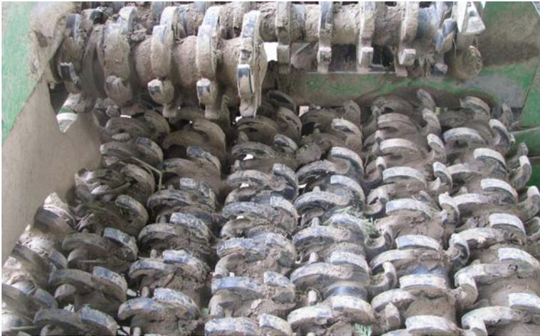
**Figure 3.1. Dessableur à doigts qui enlève la terre et change la direction des produits agricoles de 90°.**
