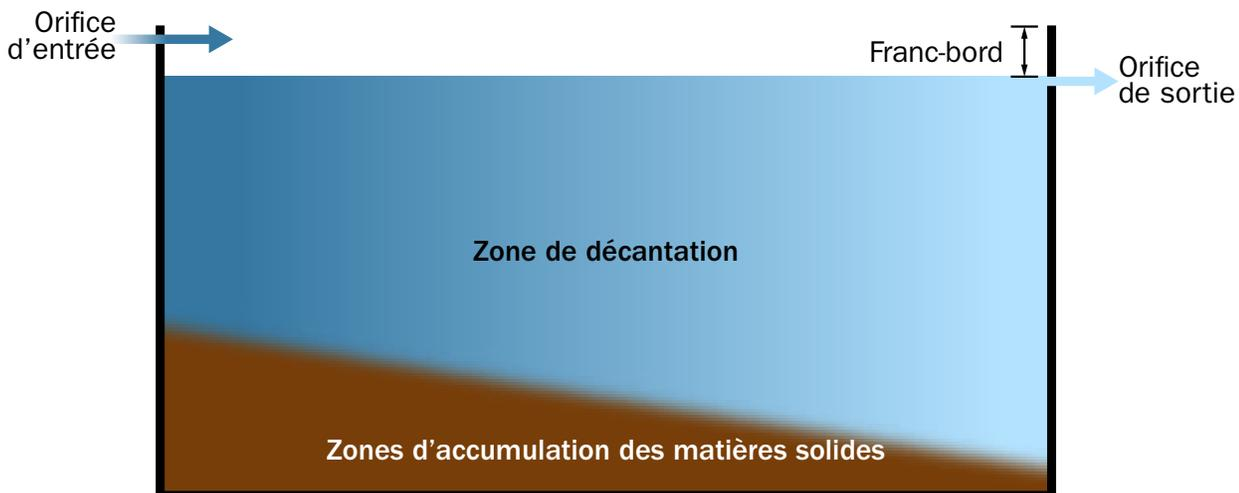
**Figure 8.26. Bassin de décantation avec des zones de décantation et d'accumulation des matières solides.**
