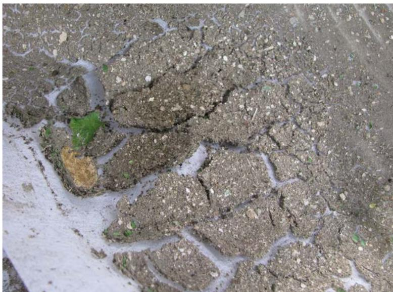
**Figure 8.10. Matières solides récoltées par le papier d'un filtre à déroulement automatique.**
