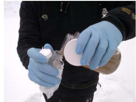
**Figure 5.6. Transfert dans une bouteille d'échantillonnage contenant un agent de préservation.**
