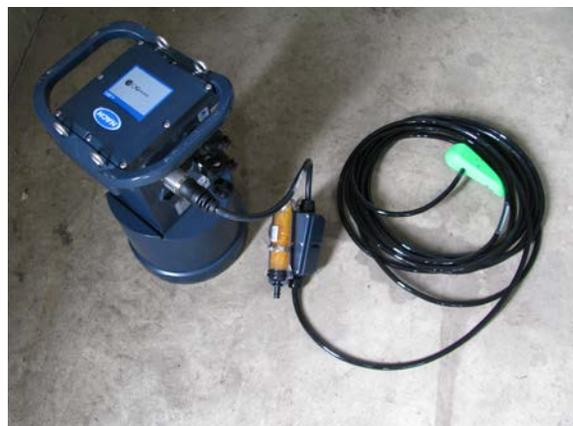
Figure 4.2. Compteur Hach FL900AV et capteur Hach Flow-Tote 3 AV.
