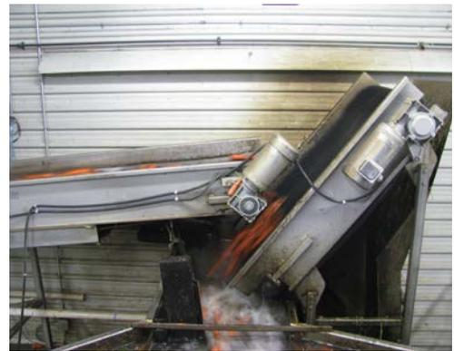
**Figure 3.3. Défaneuse installée dans une installation de lavage de carottes.**
