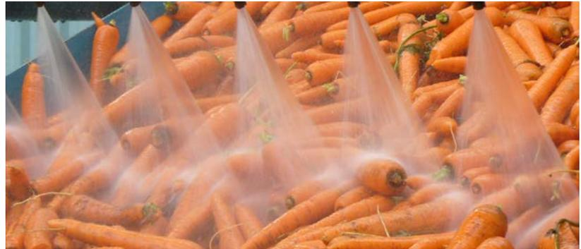
**Figure 2.10. Lavage de carottes à l'aide d'une barre de pulvérisation.**
