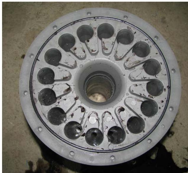
**Figure 8.13. Vue intérieure des 16 hydrocyclones d'une unité à plusieurs cyclones.**
