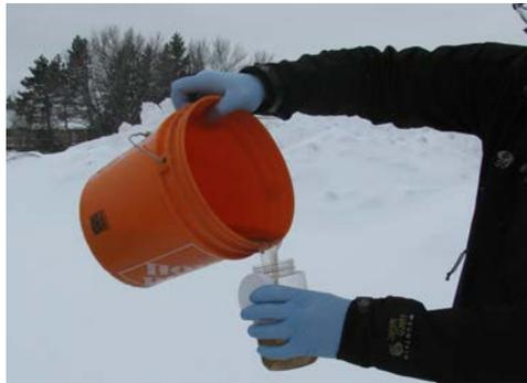
**Figure 5.5. Transfert du contenant de prélèvement à la bouteille d'échantillonnage.**
