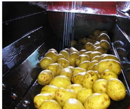
**Figure 2.12. Intérieur d'un cylindre de lavage.**
