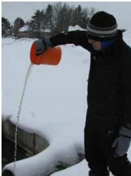
**Figure 5.4. Les procédures d'échantillonnage comprennent le triple rinçage du contenant de prélèvement.**
