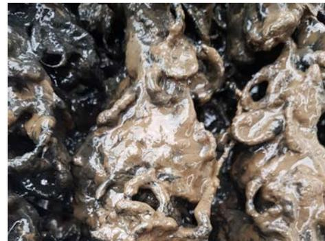
**Figure 8.34. Croissance de bactéries sur un système BioCord après 55 jours de traitement de l'eau de lavage.**
