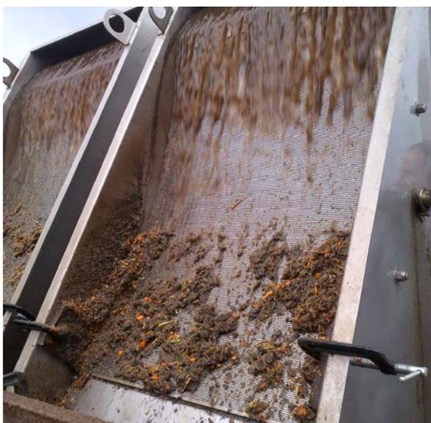
**Figure 8.2. Tamis hydraulique enlevant les débris de carotte de l'eau de lavage.**
