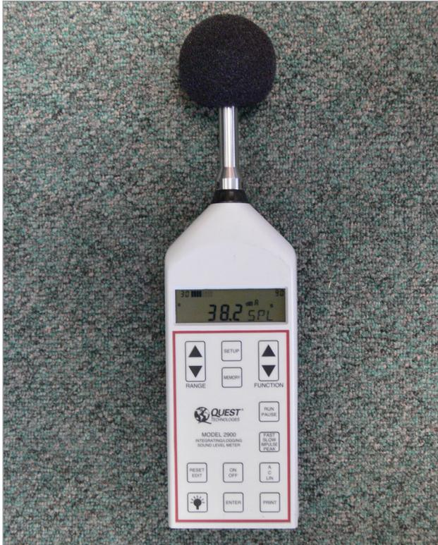
**Figure 2.** Sonomètre intégrateur avec fonction d'enregistrement des données indiquant le faible niveau sonore de 38,2 dBA dans le bureau de l'auteur. La mousse noire pare-vent amovible sert aux lectures faites à l'extérieur.
