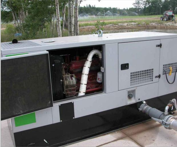
**Figure 4.** Enceinte destinée à assourdir le moteur à combustion interne d'une pompe d'irrigation stationnaire.
