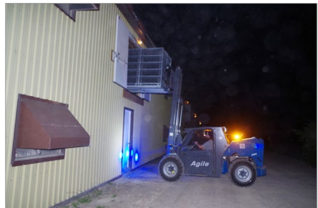
Figure 1. Chariot élévateur plaçant un module CM2A d'une hauteur de cinq tiroirs au deuxième étage d'un poulailler.
