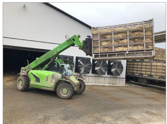
Figure 6. Télémanipulateur de marque Merlo transportant un module.
