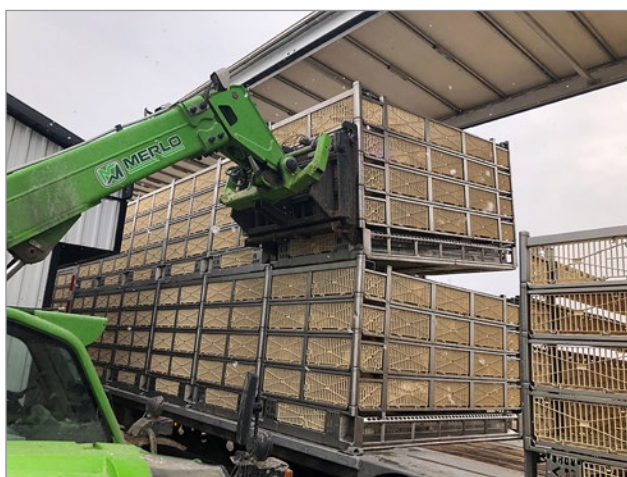
Figure 8. Mise en place du module supérieur Marel-Stork sur les doigts de positionnement supérieurs du module inférieur afin de l'arrimer pour le transport.
