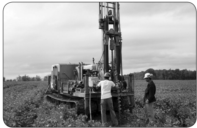
Figure 1. Appareil de forage mobile couramment utilisé pour prélever des carottes à des fins d'analyse de perméabilité du sol.
