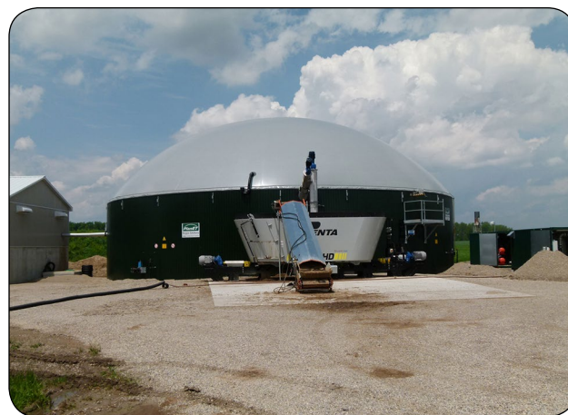
Figure 2. Le digestat produit dans des digesteurs anaérobies peut être séparé pour produire de la litière compostée.
