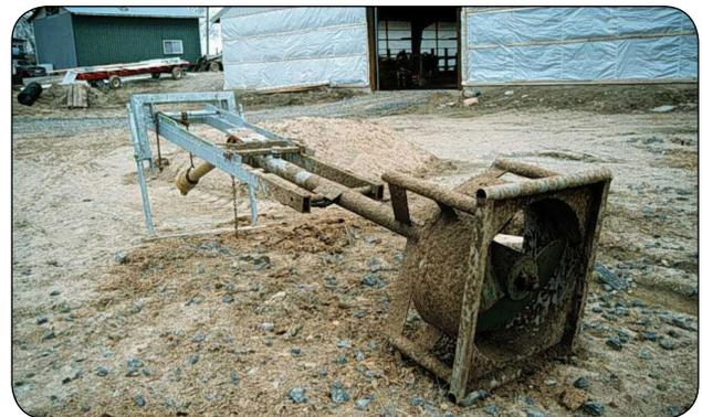
**Figure 5.** Agitateur à hélice servant à faire circuler le fumier dans une structure pourvue d'un réseau circulatoire.
