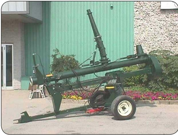
**Figure 2.** Pompe à fumier liquide verticale sur prise de force tracteur, inclinée ici pour le transport.
