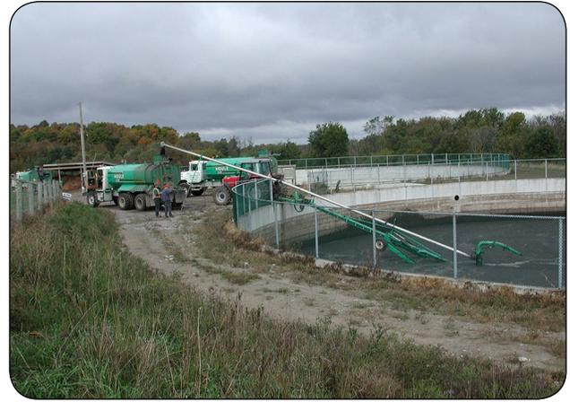
**Figure 7.** Remplissage de citernes de 11 400 L (3 000 gal) après l'agitation du fumier
