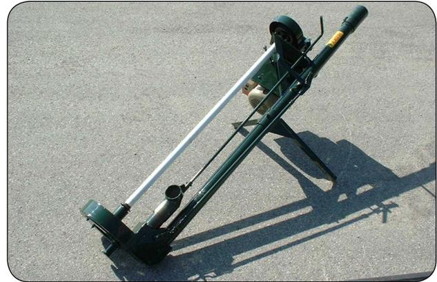
Figure 1. Pompe verticale enlevée du réservoir.
