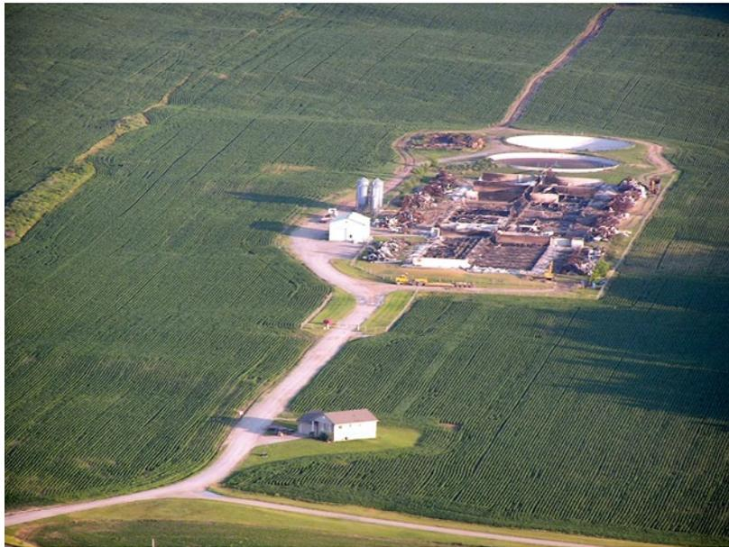
**Figure 4.2. Porcherie ravagée par les flammes. L'absence d'une voie d'accès entourant complètement les bâtiments a nui au travail des pompiers.**
