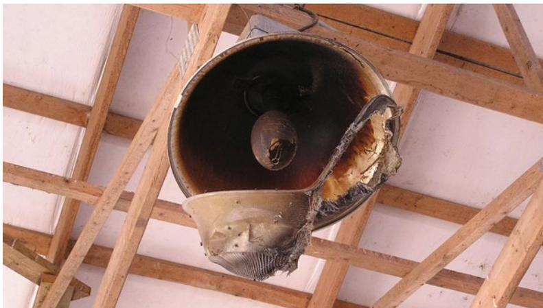
**Figure 2.2. Appareil d'éclairage ayant déclenché un incendie dans une étable laitière à cause de la présence d'un nid d'oiseaux (proximité d'un combustible).**
