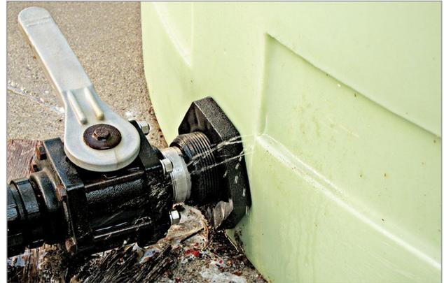
**Figure 3.** Craquelure à côté du raccord causée par la pression dans un réservoir en polyéthylène et entraînant une perte de liquide.
