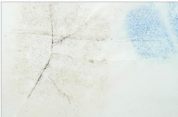
**Figure 5.** Réservoir montrant des signes de craquelures (en bleu) et de fissures (en noir) une fois coloré au moyen d'un marqueur à encre hydrosoluble.
