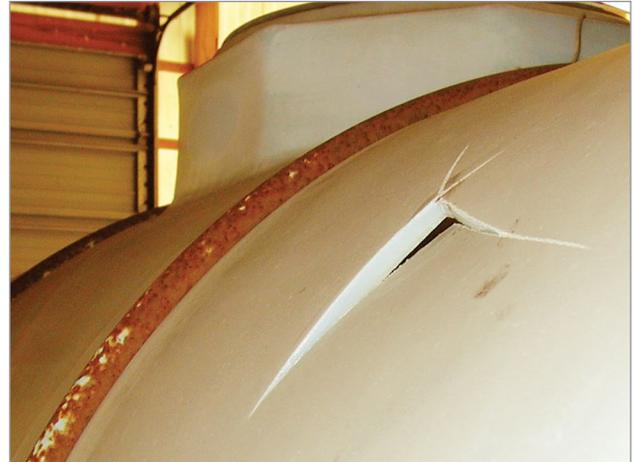
**Figure 13.** Lorsqu'on l'a frappé avec un bâton de baseball afin de déterminer sa résistance, ce réservoir a échoué au test à cause de la fragilité du plastique.
