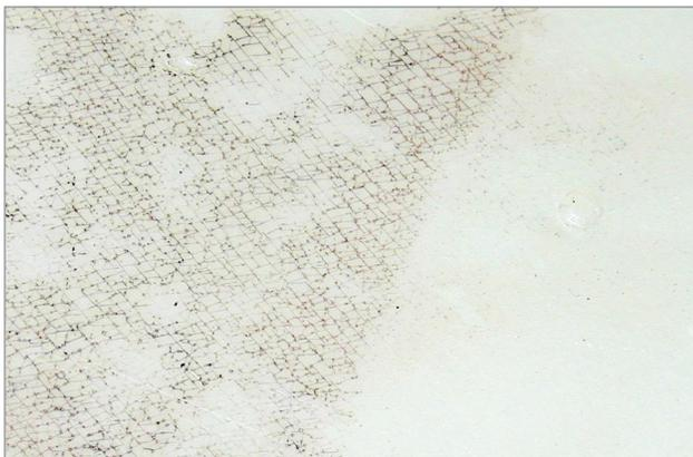
**Figure 6.** Réservoir en polyéthylène montrant des signes de craquelures une fois coloré au moyen d'un marqueur à encre hydrosoluble.
