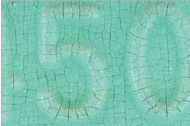
**Figure 2.** Gros plan d'un vieux réservoir en polyéthylène présentant des craquelures (fissures très fines dans la paroi).
