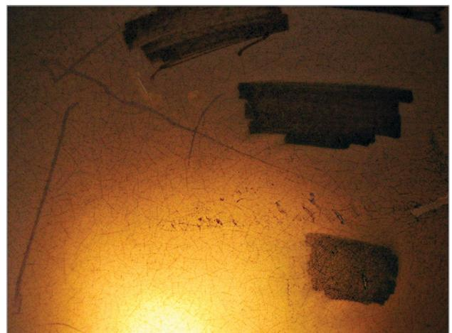
**Figure 11.** La technique du mirage révèle que le réservoir est craquelé.
