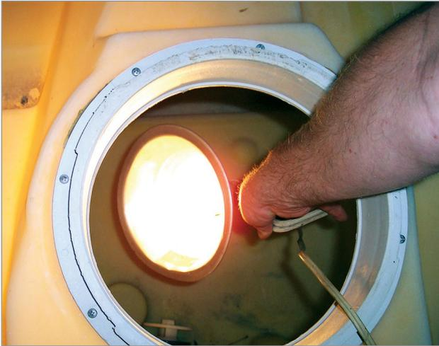
**Figure 7.** Une lumière vive est utilisée pour mirer un réservoir en polyéthylène de l'intérieur.
