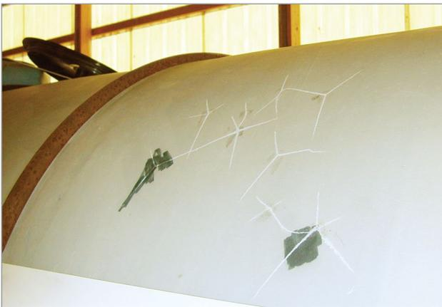
**Figure 12.** Réservoir montrant des signes de craquelures et de fissures à la suite d'un essai effectué au moyen d'un marqueur à encre hydrosoluble.
