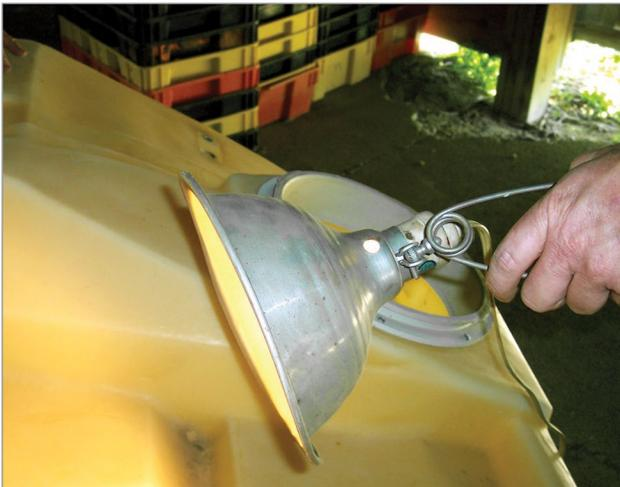
**Figure 8.** Il faut se servir d'une lumière vive pour mirer le réservoir en polyéthylène de l'extérieur. On peut détecter les défauts et les craquelures du réservoir d'après les zones ou les lignes présentant une intensité lumineuse différente (voir les figures 9, 10 et 11).
