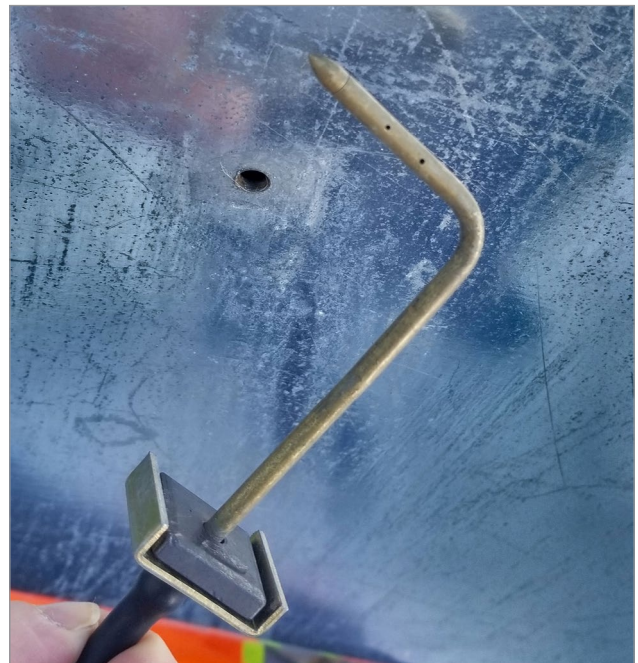
Figure 7. Un tube pour mesurer la pression statique peut être inséré dans un petit trou percé dans les conduits afin de mesurer la pression de l'air. Source : APS Dineen Farms, Kenilworth, Ontario.
