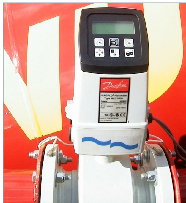
Figure 4. Exemple de débitmètre sur une citerne à fumier. Consulter un fournisseur pour connaître les produits offerts.
