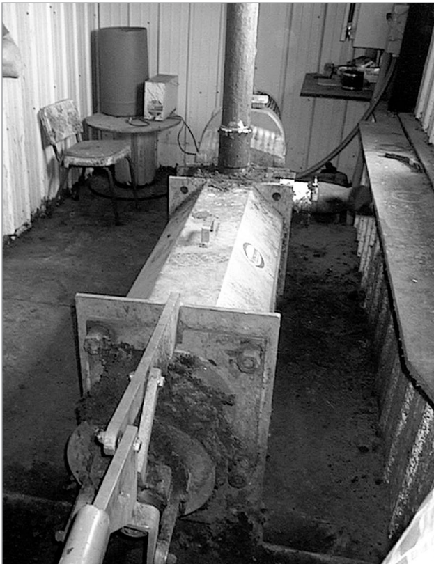
Figure 5. Séparateur à vis qui extrait les matières solides du fumier liquide.
