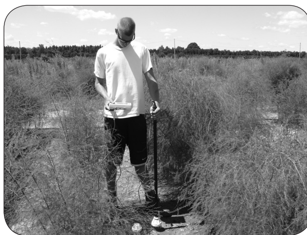
Figure 11. Personne chargée de l'irrigation insérant dans une conduite d'accès une sonde capacitive permettant de prendre des lectures à différentes profondeurs.
