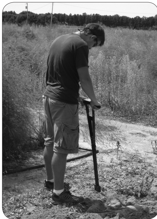
Figure 10. Personne chargée d'irriguer un champ d'asperges enfonçant dans le sol la sonde d'un réflectomètre temporel fixée à une poignée à hauteur de taille. L'appareil donne une lecture instantanée, après quoi, la sonde est retirée.
