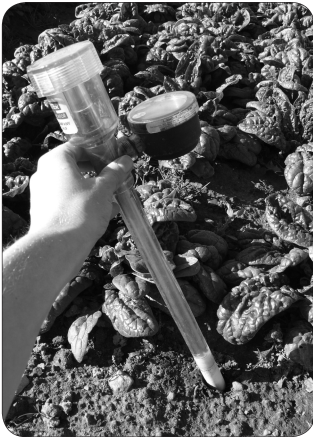
Figure 5. Pointe en céramique d'un tensiomètre insérée dans un trou de 2,5 cm de diamètre dans le sol.
