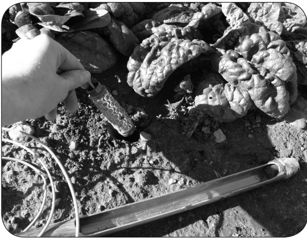
Figure 7. Insertion d'un pédohygromètre dans un trou dans le sol. Les fils d'un pédohygromètre enfoui dans le sol sont reliés à un lecteur numérique à main.
