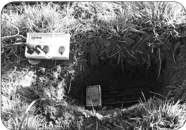
Figure 9. Réflectomètre temporel placé au fond d'un trou, à une profondeur d'environ 30 cm, dans un verger de pommiers.
