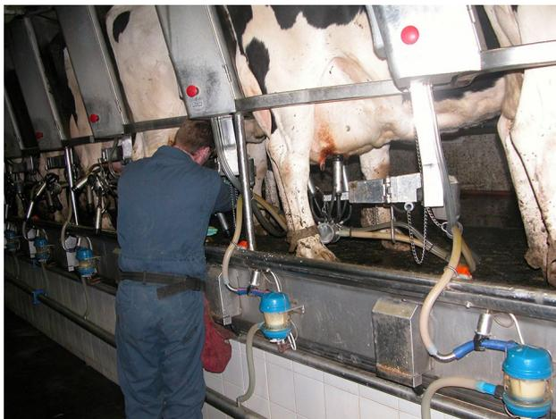
**Figure 4.** Une profondeur suffisante de la fosse de traite permet au préposé de fixer le matériel sans avoir à se pencher.
