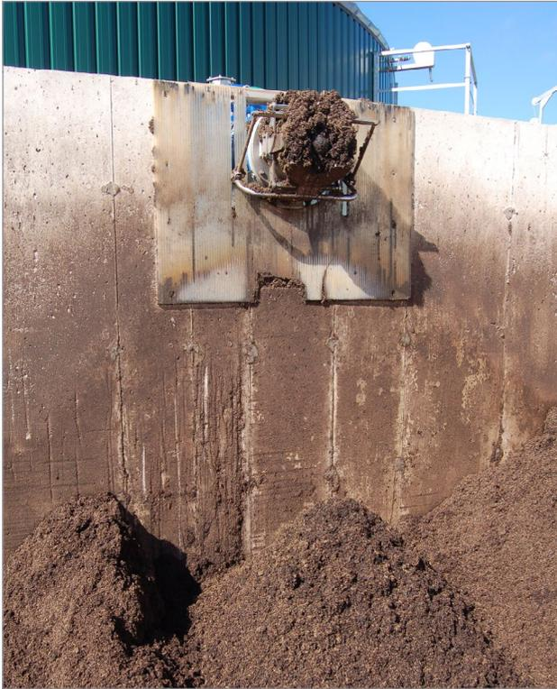
**Figure 7.** Séparateur de fumier relié au digesteur anaérobie pour séparer la partie solide du digestat.
