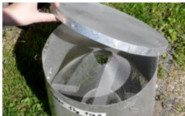
**Figure 26. Piège à mouches solaire destiné aux utilisations à l'extérieur. Ici, le couvercle a été soulevé pour montrer le cône inversé servant à piéger les mouches.**
