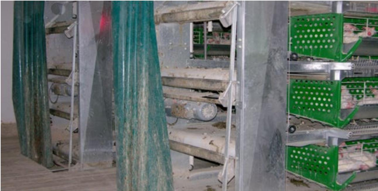
**Figure 13. Récolte mécanique des fientes par un convoyeur passant sous chaque étage de cages.**
