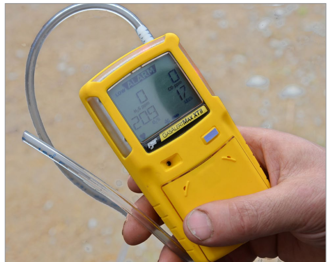
Figure 2. Exemple de détecteur à gaz multiples à main servant à mesurer les concentrations d'oxygène, de sulfure d'hydrogène et de gaz explosifs (% correspondant à la limite inférieure d'explosivité ou LIE) offerts par les fournisseurs de matériel de sécurité.
