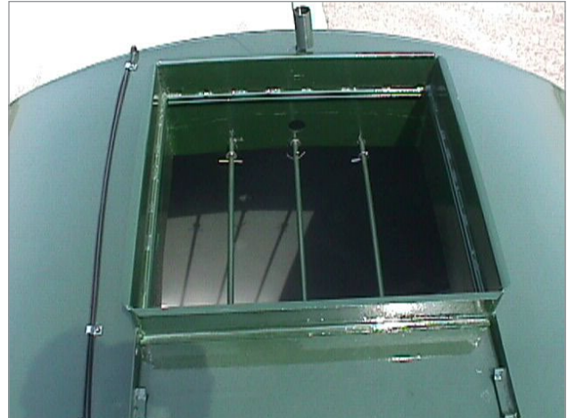
Figure 3. Trappe de sécurité pour citerne à fumier liquide.
