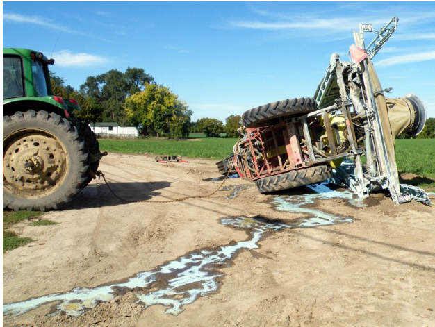
Figure 2. L'opérateur de ce pulvérisateur a causé des dommages à l'équipement et un déversement de pesticide en faisant un virage trop prononcé et trop rapide sur un sol meuble avec un réservoir plein.
