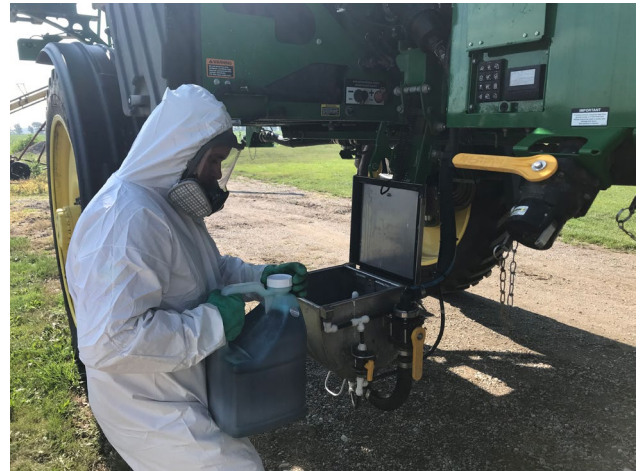
Figure 3. Il faut porter un équipement de protection individuelle approprié lorsqu'on manipule des pesticides. Ce pulvérisateur comprend un poste de mélange au niveau du sol qui facilite le remplissage tout en réduisant le risque de déversement au minimum.
