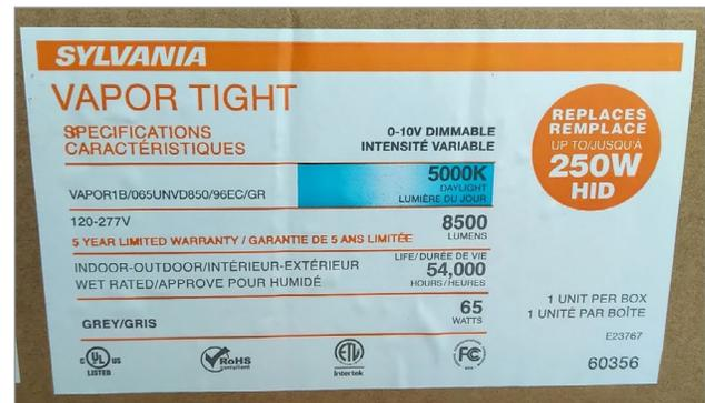
**Figure 1.** Éléments d'information habituellement fournis sur l'emballage d'un luminaire, en l'occurrence un luminaire linéaire à DEL de 8 pieds de long (environ 2,5 m) dans un boîtier étanche à la vapeur et à l'épreuve de l'eau.
