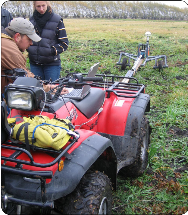
Figure 6. Recherche d'argile avec EM50.
