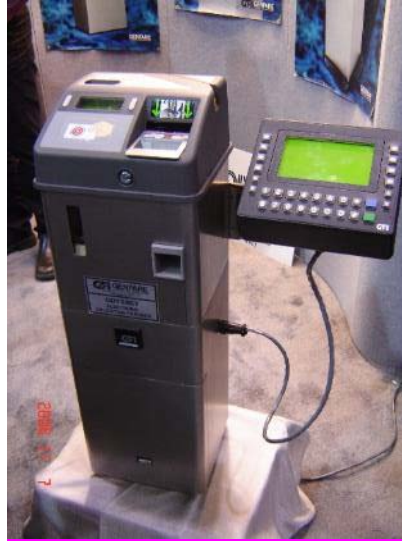
FIGURE 13 : UNE BOÎTE DE PERCEPTION ÉLECTRONIQUE COMMUNE INSTALLÉE À DES FINS DE FORMATION DANS UN CENTRE DE TRANSPORT EN COMMUN
