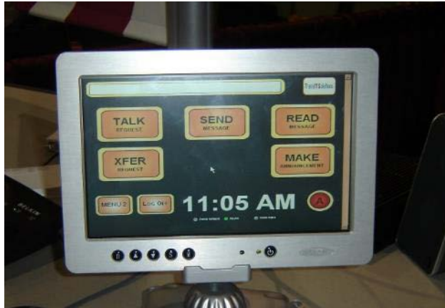
FIGURE 5 : MODULE DE COMMUNICATION VOCALE DU RÉPARTITEUR
