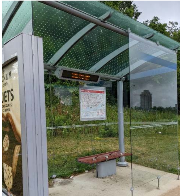
FIGURE 17 : AFFICHE PRÉSENTANT L'HEURE D'ARRIVÉE DU PROCHAIN AUTOBUS INSTALLÉE À L'INTÉRIEUR D'UN ABRIBUS
