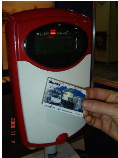
FIGURE 14 : CARTE À PUCE BALAYÉE PAR UN VALIDATEUR D'UN SYSTÈME AUTOMATISÉ DE PERCEPTION DES TARIFS
