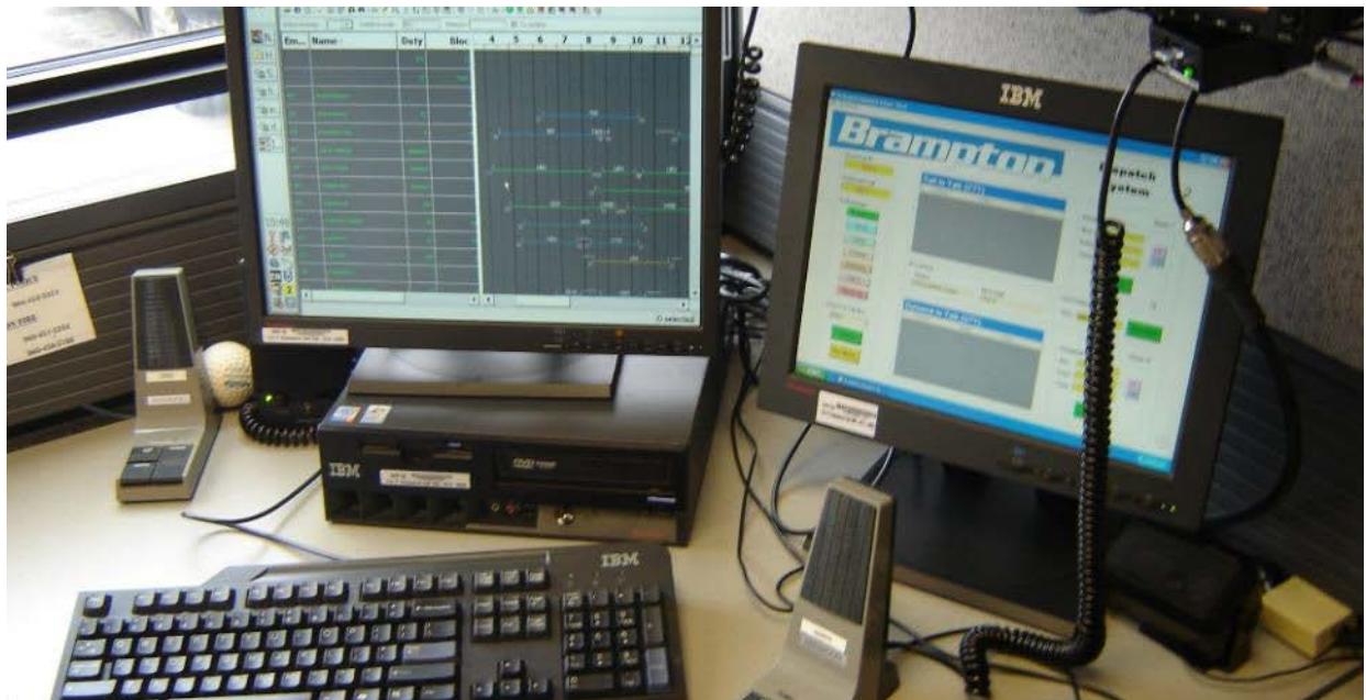
FIGURE 4 : MONITEUR DU RÉPARTITEUR SUR LEQUEL S'AFFICHE LE SYSTÈME DE RAO/LAV, AVEC MICROPHONE
