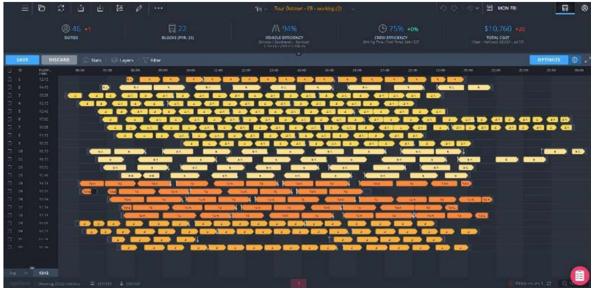
FIGURE 22 : CAPTURE D'ÉCRAN D'UN LOGICIEL DE PLANIFICATION DES ITINÉRAIRES FIXES MONTRANT COMMENT LES DÉPLACEMENTS PEUVENT ÊTRE ASSOCIÉS À DES HORAIRES ET DES VÉHICULES
