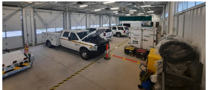
Remorque de friction de la chaussée, véhicule de rétroréflectivité mobile, véhicule de marquage et autres véhicules entreposés dans le garage du CEIT.
