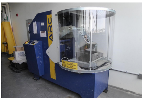
On utilise le compacteur de dalles bitumineuses pour créer des échantillons représentatifs de dalles aux dimensions variées qui sont constituées de mélanges hydrocarbonés déposées et compactées sur place.
