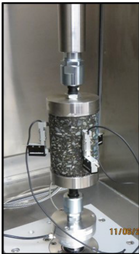
Module dynamique. Partie de l'équipement d'analyse des mélanges hydrocarbonés.
