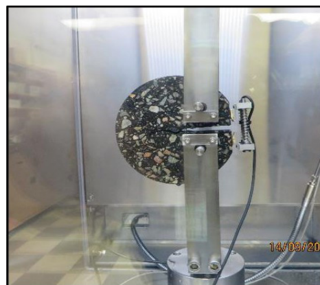
Appareil d'essai de tension compacte en forme de disque (DCT). Partie de l'équipement d'analyse des mélanges hydrocarbonés.
