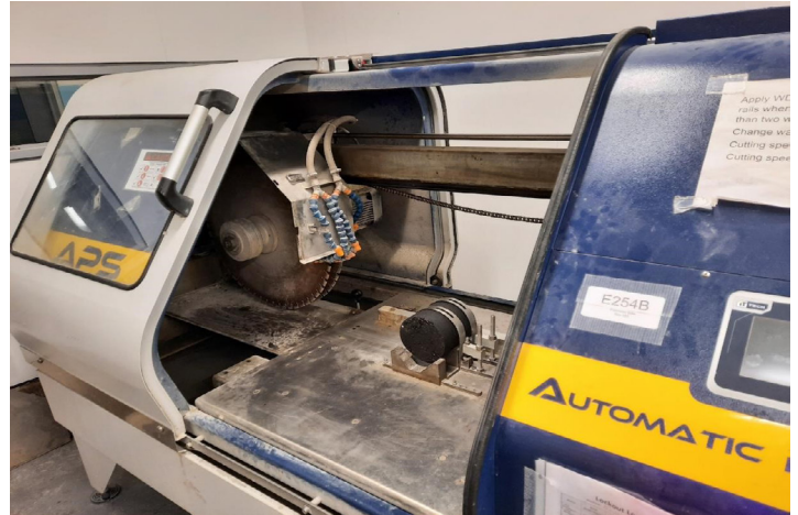
Une scie pour enrobé bitumineux dans le laboratoire du CEIT.
